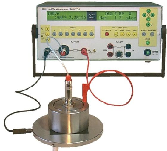
Messung Oberflächenwiderstand mit Grundplatte GP 14 und Milli-TO 3
