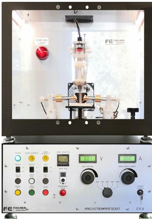
Die Kriechstromfestigkeit wird mit dem CTI-Wert (Comparative Tracking Index) bestimmt und mit dem PTI-Wert (Proof Tracking Index) geprüft.
